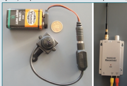
Miniaturowa kamera z mikrofonem i nadajnikiem zasilana baterią 9 V – czas pracy bez wymiany baterii około 10 h
